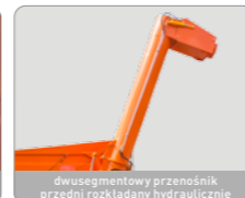
dwusegmentowy przenośnik przedni rozkładany hydraulicznie
