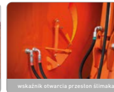
wskaźnik otwarcia przeston ślimaka
