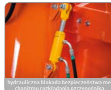
hydrauliczna blokada bezpieczeństwa mechanizmu rozkładania przenośnika
