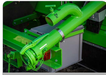
rura do zaciągu produktu na śrutownik
