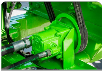
niezależna hydraulika do napędu ślimaka namieszającego
