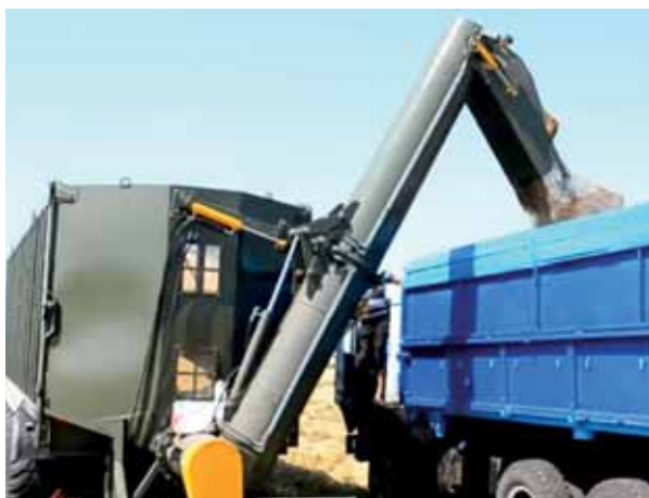
Hydrauliczna regulacja kąta nachylenia ślimaka
