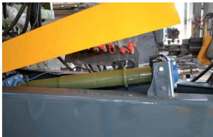
System przeciążeniowy ściany przedniej
