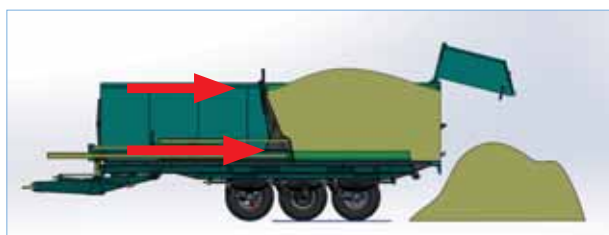
Przesuwanie dolnej części przyczepy wraz ze ścianą
