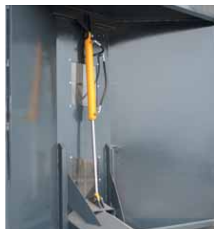
Hydrauliczna regulacja ilości wysypywanego ziarna
