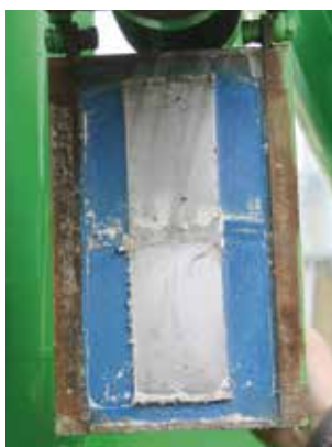
Magnes, który uniemożliwia przedostanie się do komory mieszania metalowych zanieczyszczeń
